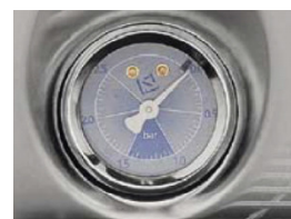
Manometer zur Kontrolle des Drucks im Kessel
